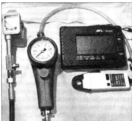
Рис. 1.33. Тестеры для проверки компрессии и утечек из камеры сгорания (слева направо): устройство для проверки компрессии, устройство для измерения падения давления, мотор-тестер для измерения силы тока стартера
