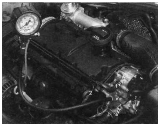
Рис. 7.3. Подсоединение манометра для проверки давления подкачки топлива (стрелкой показан штуцер для проверки давления подкачки топлива): 1 — топливоподводящая магистраль; 2 — магистраль обратного слива топлива
