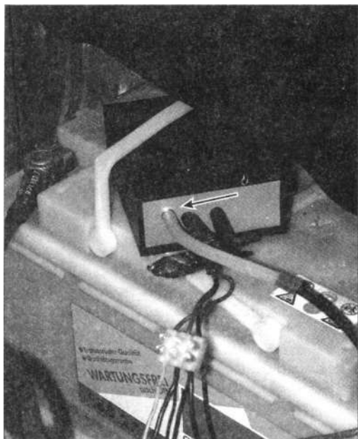
Рис. 1.77. Дополнительный блок управления двигателя TDI помещен на аккумуляторную батарею только для фотографирования. Стрелкой указано подсоединение давления наддува
