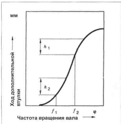
Рис. 8.6. Изменение начала подачи топлива с f_1 (раннее впрыскивание топлива) на f_2 (позднее впрыскивание топлива) путем перестановки дополнительной втулки (источник: Bosch [22])
