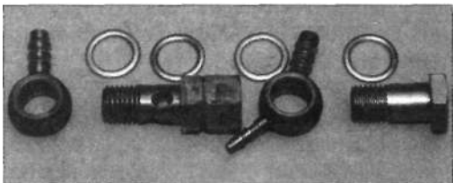
Рис. 1.27. Адаптер, для измерения давления в распределительных насосах Bosch
