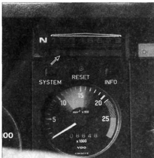
Рис. 8.8. Дисплей диагностической системы автомобиля (VDS-дисплей)
