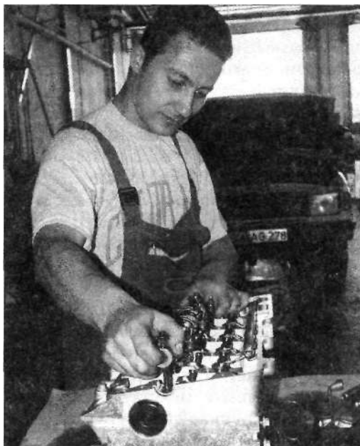
Рис. 6.26. Демонтаж оси с коромыслами
