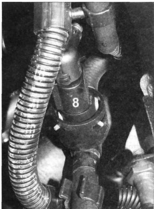
Рис. 7.4. Датчик температуры топлива 8 расположен в топливопроводе обратного слива топлива
