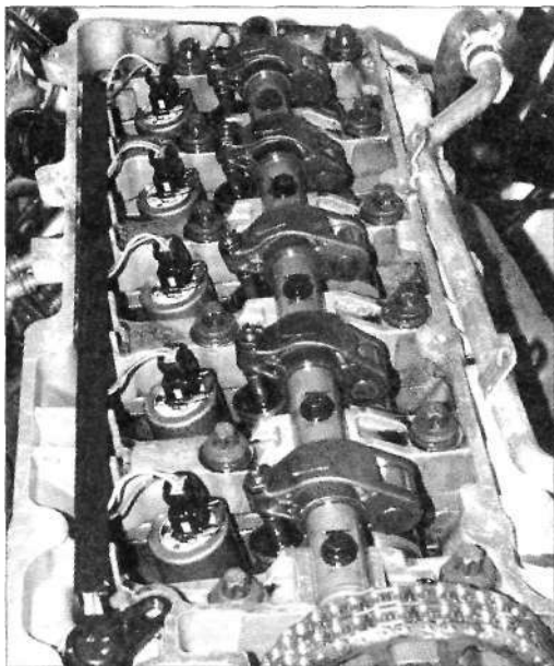
Рис. 6.1. Насос-форсунки Lucas/Delphi в головке блока цилиндров пятицилиндрового двигателя Land Rover
