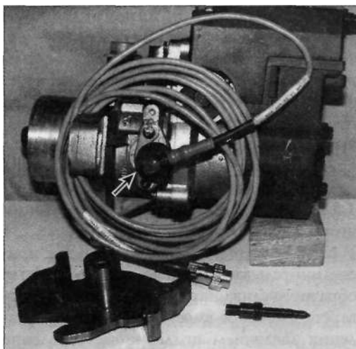
Рис. 1.26. Монтаж датчика типа RI на распределительном ТНВД EPIC фирмы Lucas. Блокировочный штифт и данный датчик типа RI для рядных насосов не подходят
