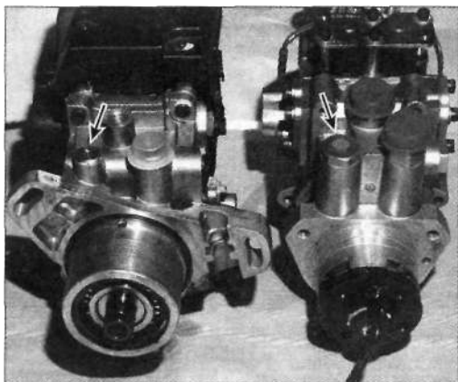
Рис. 1.30. ТНВД EPIC фирмы Lucas: стрелки указывают на места подключения манометров
