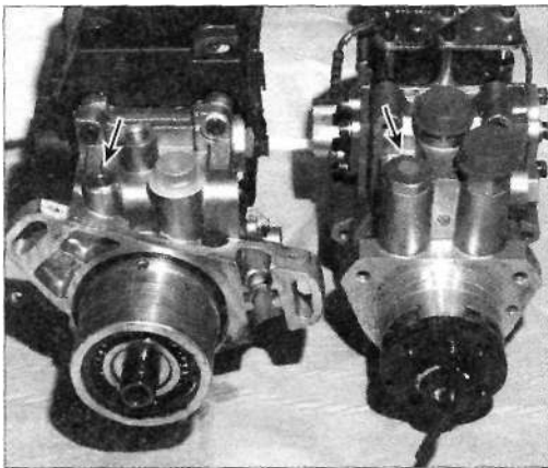
Рис. 4.9. На месте заглушки (показана стрелкой) монтируется манометр для измерения низкого давления
