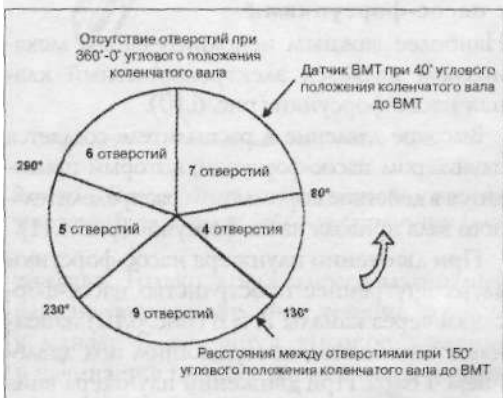
Рис. 6.5. Распределение отверстий-меток на маховике пятицилиндрового двигателя (источник: Rover Deutschland [11])
