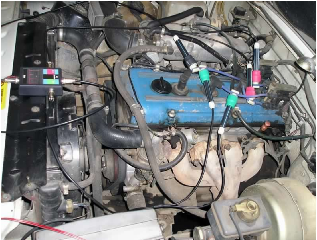
Conexión de sondas de alta tensión.
