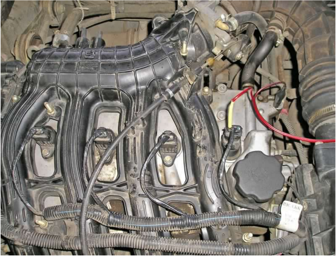
Conexión de la sonda del osciloscopio al cable de operación de la bobina primaria de la bobina de encendido individual.
